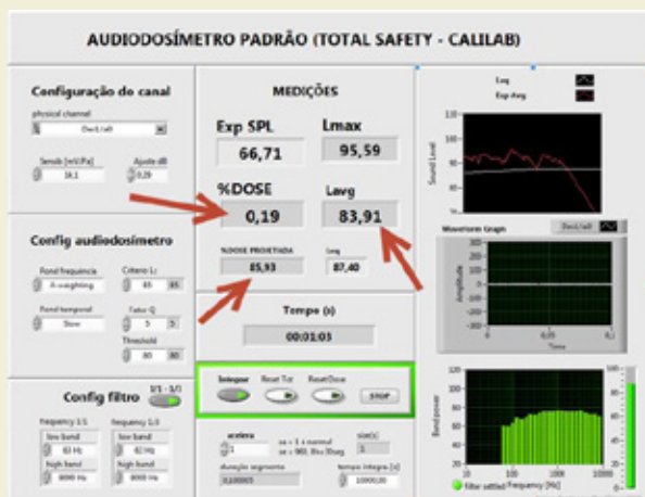
Figura 6: Painel de operação e leitura do audiodosímetro padrão com indicação direcionada para %Dose, L_{avg} e % Dose Projetada para 8 horas
