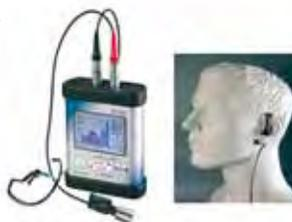
Figura 3 – Audiodosímetro – SVANETEK mod SV 102.
