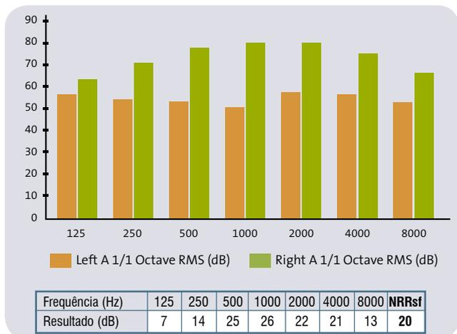
Figura 8 – Tabela exemplo de atenuação com Audiódosímetro com dois canais.
