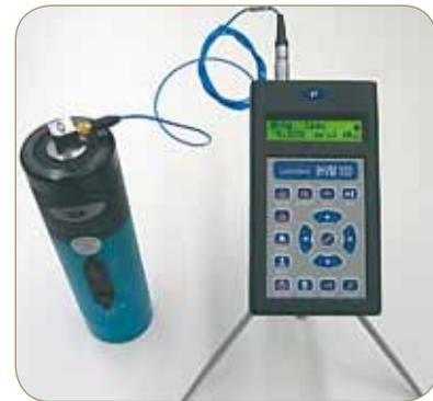
Figura 04 – Calibração do Medidor de Vibração CE
