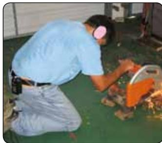
Figura 4: Operação da serra circular abrasiva para aço de 14 polegadas
