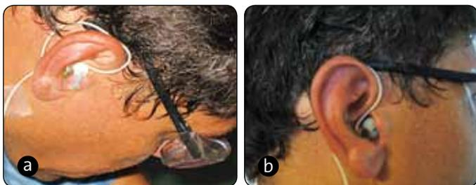
Figura 1: Microfones utilizados para a medição de perda de ruído por inserção, (a) em operação de ferramenta e (b) vista lateral do rosto.
