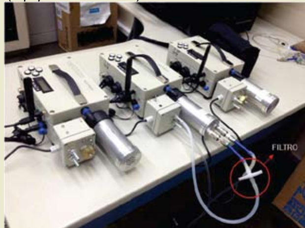
Figura 8 - RadonMapper® em modo ativo (equipamento central)
